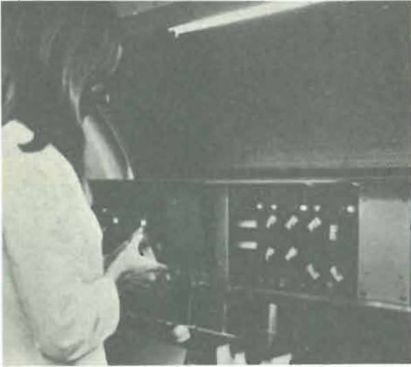
Fig. 4 - Pannello di controllo d'un forno a diffusione entro la Camera Bianca: applicazione del fotoresist ad un wafer LSI/MOS.
